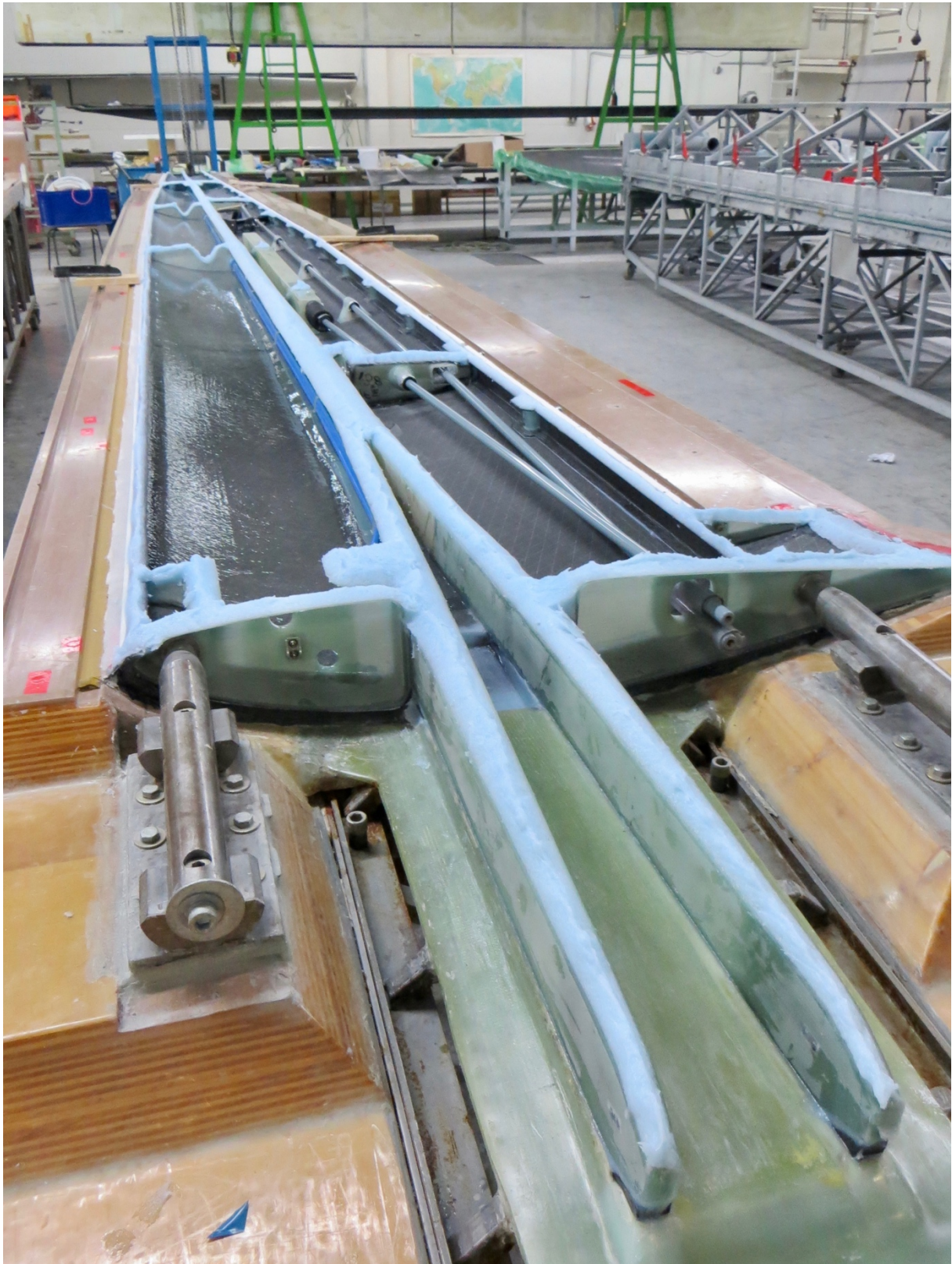
Afbeelding 1-5 Constructie kunststof vleugel
